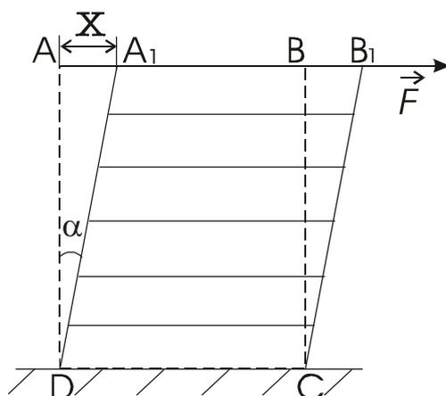
Рис. 1. Схема деформации сдвига
