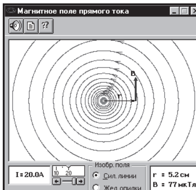
Рис. 4.1.1. Магнитное поле прямого тока
